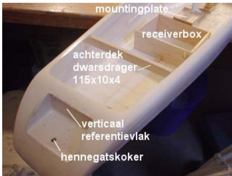
Figuur 8 spanten en dekdrager achter
