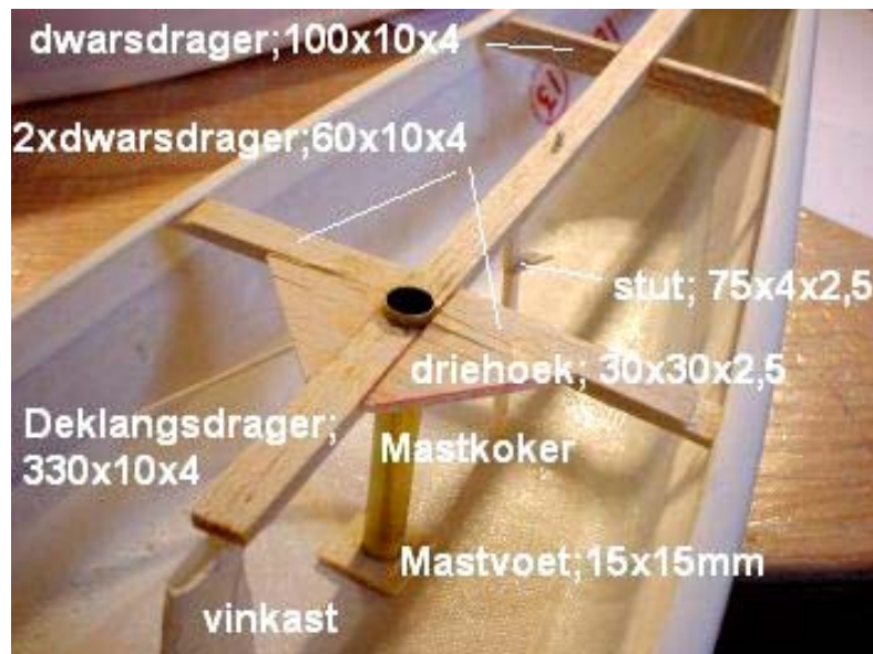
Figuur 3 Dekbalken met mastkoker
